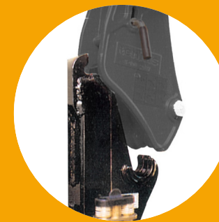
Voorlader stabiel verbonden met subframe
